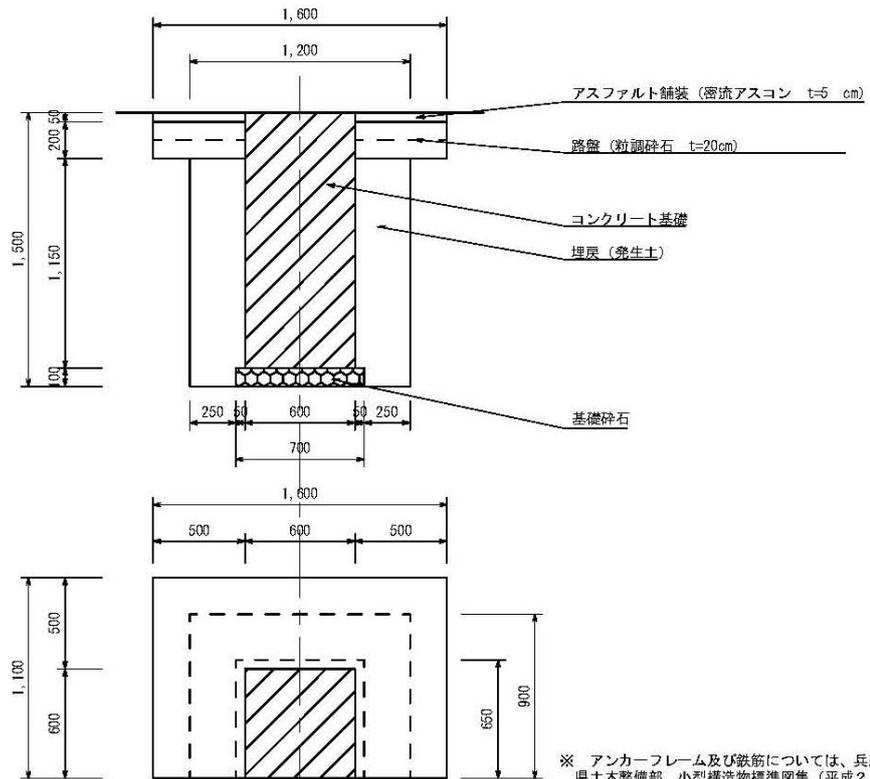
※ アンカーフレーム及び鉄筋については、兵庫県土木整備部 小型構造物標準図集 (平成25年12月) を参照のこと
