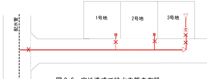
図8-6 宅地造成で給水主管を布設
