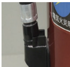
× 消火薬剤の漏れ
