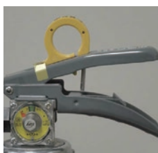
× レバー支えの脱落
