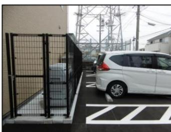
●駐車マスとフェンスとの隙間が狭く、跳ね上げ式や横開き式の後部ドアを十分に開くことや、スロープを取り付けることが出来ない。
