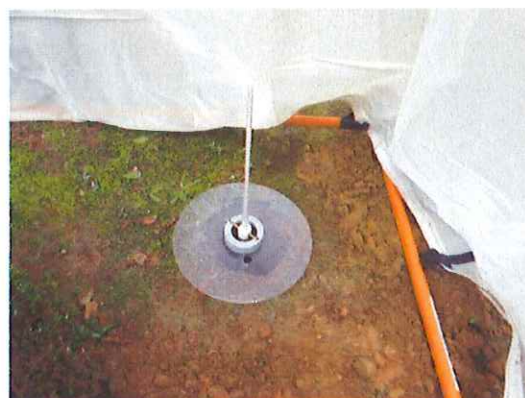
透水試験作業中
